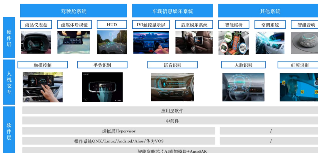
图3 智能座舱的具体构成
